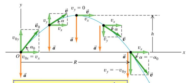
$$x = (v_0 \cos \alpha_0)t ; y = (v_0 \sin \alpha_0)t - \frac{1}{2}gt^2$$
